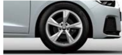
アルミホイール 5アームスタースタイル 7.5J×17+215/45 R17タイヤ [Audi A1 Sportback 35 TFSI advancedに標準装備]
