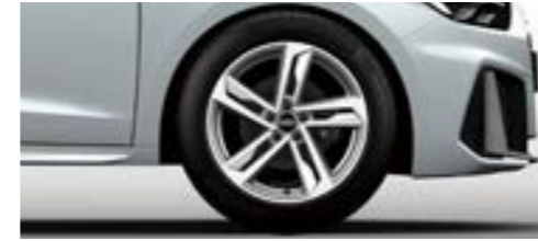
アルミホイール 5ダブルスポークスタイル パートリーポリッシュ 7.5J×17+215/45 R17タイヤ [Audi A1 Sportback 25 TFSI S line, A1 Sportback 35 TFSI S lineに標準装備]
