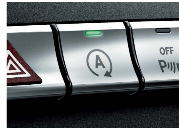
ECOスタートストップ機能(アイドリングストップ機能)
