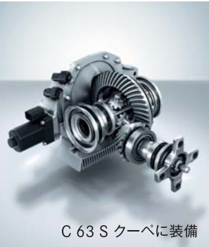
C 63 S クーペに装備 電子制御AMGリミテッド・スリップ・デフ
