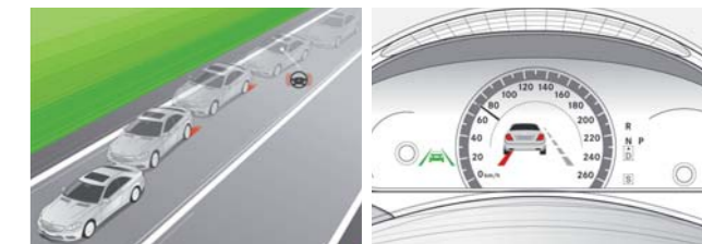
車線修正のために軽いブレーキが適用されたときのディスプレイ表示
