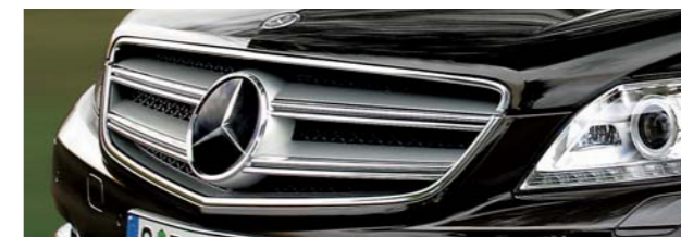
フロントグリル中央に内蔵される長距離レーダーユニット
