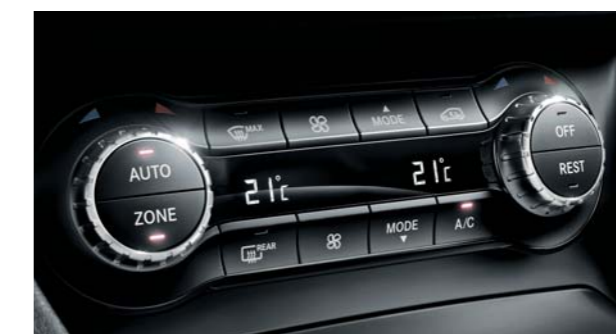
それぞれに最適な快適性を実現する クライメートコントロール(左右独立調整)
