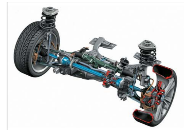
マクファーソンストラット式フロントサスペンション
