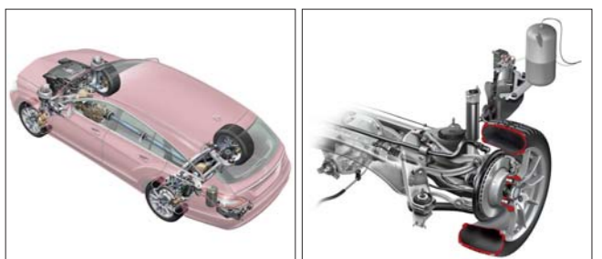
セルフレベルリング付リアエアサスペンション AIRマティックサスペンション
