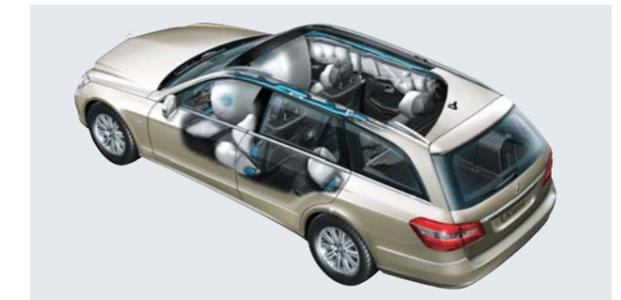
\*SRSは、Supplemental Restraint System(乗員保護補助装置)の略称。エアバッグは、シートベルト着用を条件にその効果が発揮されます。安全のため全乗員のシートベルト着用をお願いします。原則として衝撃が軽度の場合、また一度展開した後は作動しません。運転席・助手席エアバッグ、ニーバッグは、前方からの衝撃により作動し、側面及び後方からの衝突や横転・転覆時には作動しません。サイドバッグ、ウインドウバッグ及びペルビスバッグは側面方向からの衝撃により作動し、前方及び後方からの衝突時には作動しません。
