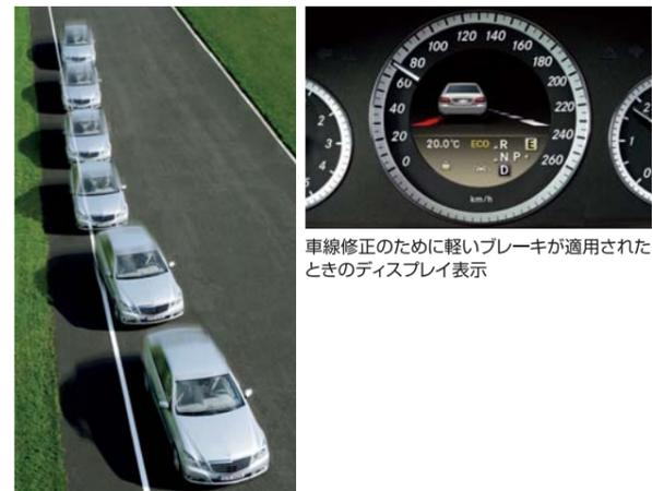
車線修正のために軽いブレーキが適用されたときのディスプレイ表示
