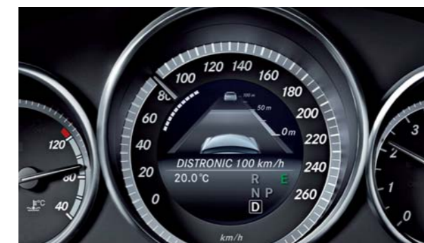
ディストロニック・プラス(ステアリングアシスト付)のディスプレイ表示
