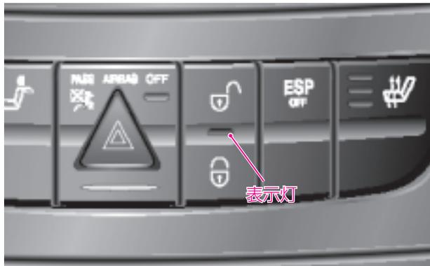
ドア、テールゲート、ボンネットなどが閉じていることを監視し、車がリモコン以外の方法で開けられたときや、ウインドウを割って中からドアを開けられたとき、けん引などにより車両が傾くのを感知すると、サイレンと非常点滅灯の点滅で周囲に知らせます。
