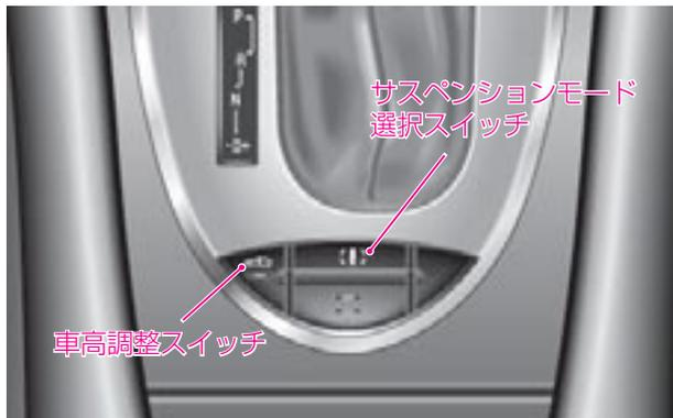
AIRマティックDC(デュアルコントロール)サスペンションは、運転のスタイルや路面状況などに応じて、サスペンションや車高を最適な状態に自動調整します。
