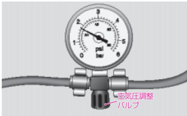
12 空気圧調整バルブが完全に閉じていることを確認して、エンジンスイッチを1の位置にします。
