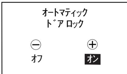
走行速度が約15km/h以上になると、ドアとテールゲートを自動的に施錠する機能の設定を切り替えることができます。
