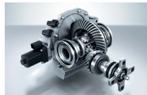
電子制御AMGリミテッド・スリッ・デフ
