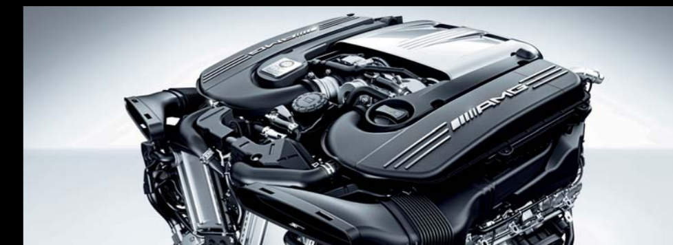
4.0ℓ V型8気筒直噴ツインターボエンジン
