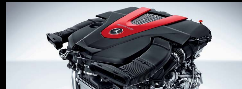
3.0ℓ V型6気筒直噴ツインターボエンジン
