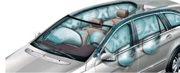
\*SRSは、Supplemental Restraint System(乗員保護補助装置)の略称。エアバッグは、シートベルト着用を条件にその効果が発揮されます。安全のため全乗員のシートベルト着用をお願いします。原則として衝撃が軽度るとき、または一度展開した後は作動しません。運転席・助手席エアバッグは、前方からの衝撃により作動し、側面及び後方からの衝撃や横転・転覆時には作動しません。サイドバッグ及びウインドウバッグは側面方向からの衝撃により作動し、前方及び後方からの衝突時には作動しません。
