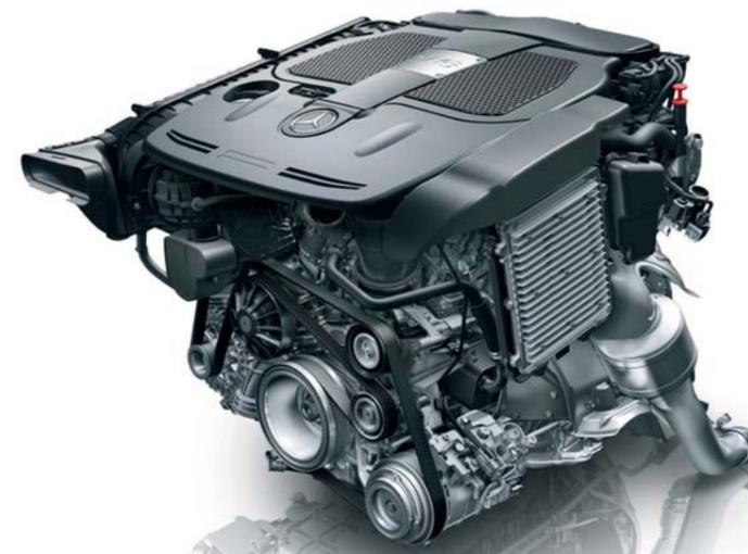
卓越した走りと環境性能を両立させた新開発3.5ℓ V型6気筒BlueDIRECT(ブルーダイレクト)エンジン。第3世代の直噴システムを用いた最先端のBlueDIRECTテクノロジーを採用。新開発のピエゾインジェクター(最大圧力200bar)とスプレーガイド式燃焼システムによって1万分の1秒の反応速度で1回の吸気行程につき最大5回の噴射を行い、常に最適な燃焼状況を作り出します。そして、新採用の成層燃焼方式は、エンジン負荷をモニターすることで冷間始動時や高負荷時などは均質燃焼、巡航時には成層燃焼など常に最適な燃焼方式を自動的に選択。意識することなく、低燃費で環境に優しい運転が可能です。従来モデルに比べて約15%の燃費向上を実現。さらに、225kW(306PS)の最高出力と、370N・m(37.7kg・m)の最大トルクを発揮。従来のV型6気筒エンジンに比べ、出力で25kW(34PS)、トルクで20N・m(2kg・m)向上させました。高出力と大幅な低燃費性、CO<sub>2</sub>排出量削減による環境適応性を高いレベルで両立させています。
