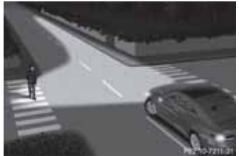
コーナリングライトは、コーナリング時に進行方向の路面を広く照射し、夜間の交差点などで運転者の視界を向上させます。ロービームヘッドライトが点灯しているときのみ、作動します。
