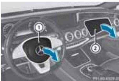
運転席エアバッグ①は、ステアリング前面で作動します。助手席エアバッグ②は、グローブボックスの前面と上部で作動します。
