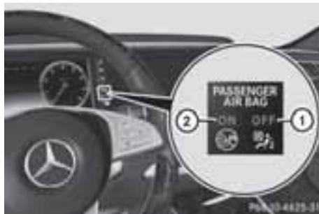
助手席エアバッグオフ表示灯 ① および助手席エアバッグオン表示灯 ② は、助手席エアバッグ自動解除システムの一部です。表示灯は助手席エアバッグの状況を示しています。
