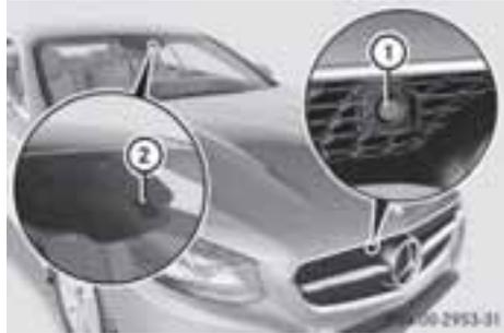
通常のヘッドライトの照明に加え、ナイトビューアシストプラスは赤外線を利用して路面を照射します。ナイトビューアシストプラスのカメラ②は赤外線を検知して、マルチファンクションディスプレイにモノクロ画像を表示します。ディスプレイに表示される画像は、ハイビームヘッドライトにより照らされた道路に相当するものです。これにより、進行方向の道路状況や障害物を素早く確認することができます。歩行者検知が作動しているときは、システムによって検知された歩行者がナイトビューアシストプラスの表示に小さな角枠とともに、色付きで視覚的に強調されます。
