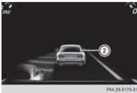
車線修正ブレーキが適用された場合は、ドアミラーの赤色の警告灯①が点滅して、警告音が2回鳴ります。加えて、側面衝突の危険性を強調した表示②がマルチファンクションディスプレイに表示されます。
