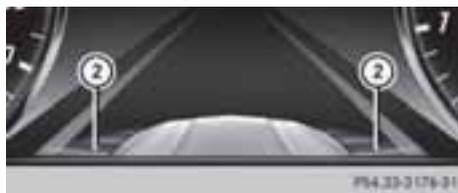
アクティブブラインドスポットアシストが設定されているときは、後方に発信される灰色のレーダー波がマルチファンクションディスプレイのアシストディスプレイの車両脇に表示されます。30 km/h以上の速度で、アシストディスプレイのレーダー波の色は緑色に変わります②。そして、アクティブブラインドスポットアシストが使用可能になります。
