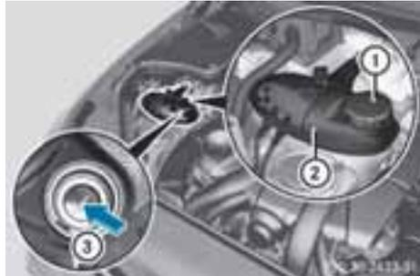
冷却水リザーブタンク ② 内の冷却水レベルが低すぎる場合は、水平な場所に停止し、エンジンが冷えているときに冷却水を補給してください。
