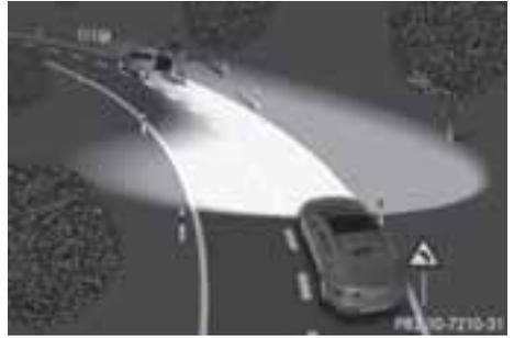
アクティブライトシステムは、前輪の操舵角に応じてヘッドライトを動かすシステムです。そのため、走行中はステアリングを操作した方向が常に照射されます。このシステムにより、歩行者、自転車、動物などを容易に認識することができます。
