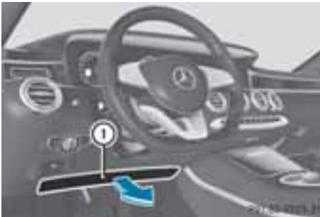
運転席ニーバッグ①は、ステアリングコラムの下で作動します。運転席ニーバッグは、フロントエアバッグと一緒に作動します。
