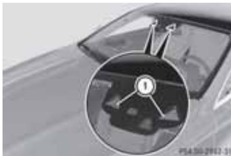
ステアリングアシストおよびストップ&ゴーパイロット付ディストロニック・プラスは、0 ~ 200 km/h の速度域で、緩やかなステアリングの介入により、車両を走行車線の中央に保つ支援をします。これは、フロントウインドウ上部のカメラシステム ① によって車両の前方エリアをモニターします。
