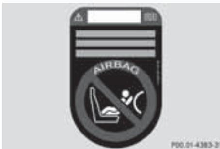
車両の助手席シートに助手席エアバッグ自動解除システムがない場合は、専用のステッカーによって示されます。ステッカーは、助手席側ダッシュボードの側面に貼付されています。助手席ドアを開いたときに、このステッカーが見えます。この場合は常に、後ろ向き乗員保護装置を適切にリアシートに取り付けてください(▶ 69 ページ)。
