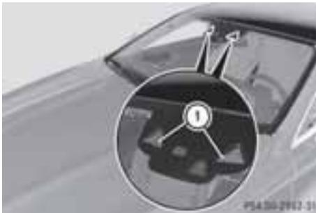
アクティブレーンキーピングアシストは、フロントウインドウ上部のカメラシステム①で車両前方のエリアをモニターします。レーダーセンサーシステムの支援により、車両の前方、後方および側方の他の様々なエリアもモニターされます。アクティブレーンキーピングアシストは道路の車線マークを検知し、意図せずに車線から外れる前に警告を発します。警告に反応しない場合は、車線修正ブレーキを適用することにより、車両を元の車線に戻すことができます。
