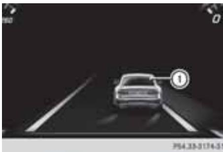
車線修正ブレーキの適用が行なわれた場合は、マルチファンクションディスプレイに①が表示されます。ブレーキの適用により、走行速度も少し低下します。
