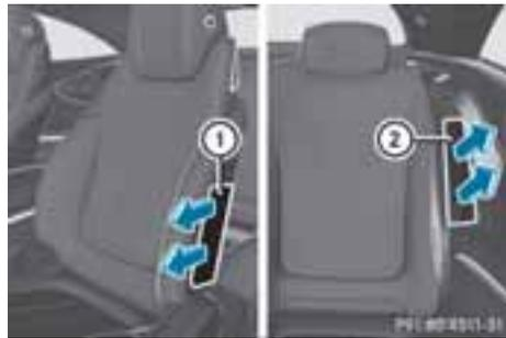
フロントサイドバッグ①およびリアサイドバッグ②は、シートバックレストの外側クッション脇で作動します。
