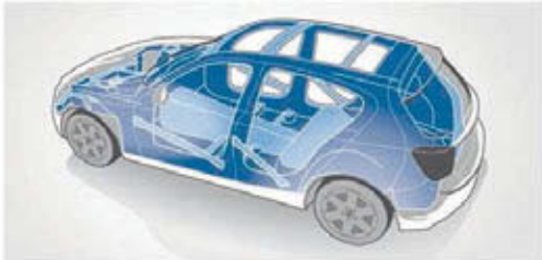
ボディ・シェル ：高い剛性を誇る補強材や高強度素材を効果的に使用したボディ。前面・側面・後面からのいかなる衝突に対しても、最大限のパッシブ・セーフティを実現します。衝突時には、クラッシュパブル・ゾーンが変形することで衝撃エネルギーを分散させて吸収。車両前後の設計されたセクションのみが効果的につぶれ、乗員を保護します。
