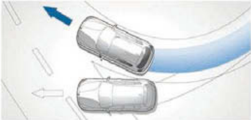
DSC (ダイナミック・スタビリティ・コントロール) ：高感度センサーが車の挙動を常にモニターしており、スリップやスライドの兆候を感知すると、エンジン出力やブレーキを制御して瞬時に走行安定性を確保します。DTCボタンを押せば、タイヤのスリップやスライドを一定限度まで許容し、駆動力を最大限に保持したよりスポーティな走りを実現します。
