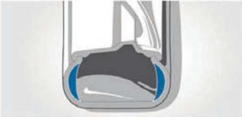
ランフラット・タイヤ ：タイヤのサイド・ウォールが強化されているため、パンクした場合でも、タイヤが完全につぶれたり、リムから外れたりすることなく、一定距離を走り続けることができます。空気圧の低下を感知すると、点灯してドライバーに知らせるタイヤ空気圧警告システムも装備。
