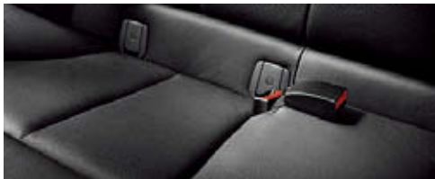
■ ISO FIXチャイルド・シート・アタッチメント ：左右のリヤ・シートに組み込まれているアタッチメントを介して取り付けるため、走行時やブレーキング時でも、チャイルド・シートの安定が保たれます。
