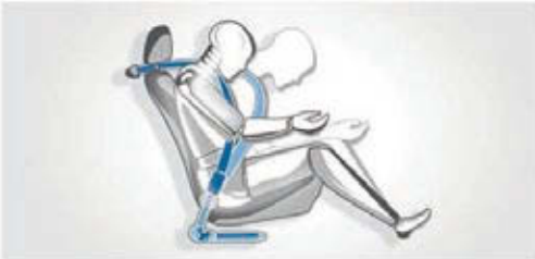
レストレイント・システム ：運転席、助手席および後席ともに3点式シートベルトを装備。さらに運転席と助手席にはシートベルト・テンショナー、衝撃力に応じて拘束力を制御するシートベルト・フォース・リミッターが装備され、万一の衝突時にも乗員を最大限に保護します。
