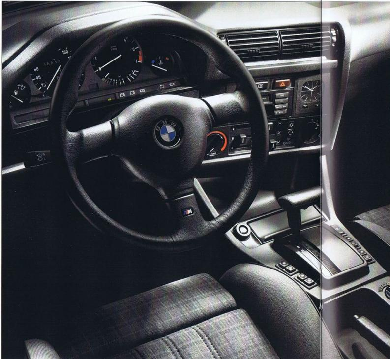
ムを積極的に採用しています。まず、SI/サービス・インターバル・インジケーターは、スター・タコメーター、スピードメーター、エンジン温度センサーから送られてくる信号を演算し、次回の整備やオイル交換時期を判断して、ドライバーに表示します。日本では法令が定める定期点検整備時期に従う必要がありますが、この装置はドライバーが自分の運転習慣を把握する目安となり、安全性を向上させる上で役立つものです。
