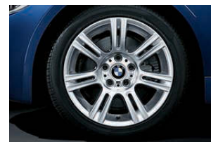
M ライト・アロイ・ホイール・ダブルスポーク・スタイリング194M ：(フロント)8J×17ホイール、225/45R17タイヤ、(リヤ)8.5J×17ホイール、255/40R17タイヤ [ランフラット・タイヤ]
