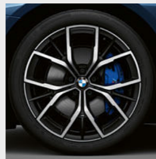
* 19インチ M ライト・アロイ・ホイール Y スポーク・スタイリング845M パイ・カラー (ジェット・ブラック)* : (フロント) 8J×19ホイール、 245/40R19タイヤ、 (リヤ) 9J×19ホイール、 275/35R19タイヤ [ランフラット・タイヤ]
