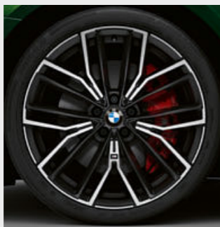
□ 20インチ M ライト・アロイ・ホイール Y スポーク・スタイリング846M パイ・カラー (ジェット・ブラック)* : (フロント) 8J×20ホイール、 245/35R20タイヤ、 (リヤ) 9J×20ホイール、 275/30R20タイヤ [ランフラット・タイヤ]
