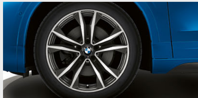
* 19インチ M ライト・アロイ・ホイールYスポーク・スタイリング722M: 8J×19ホイール、225/45R19タイヤ〔ランフラット・タイヤ〕
