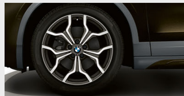
19インチ M ライト・アロイ・ホイール Y スポーク・スタイリング 722M : 8J×19ホイール、225/45R19タイヤ(ランフラット・タイヤ)
