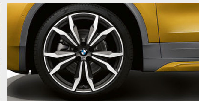
20インチ M ライト・アロイ・ホイール・ダブルスポーク・スタイリング 717M : 8J×20ホイール、225/40R20タイヤ(ランフラット・タイヤ)
