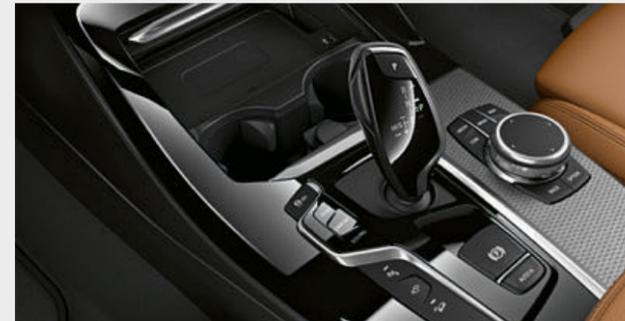
ドライバーの走行スタイルに適應する8速スポーツ・オートマチック・トランスミッションは、快適なクルージングから極めてダイナミックな走りまで、いかなる状況にも完璧に対応します。シフト・チェンジは、スポーティなデザインのセレクター・レバーまたはステアリング・ホイールに装備されたシフト・パドルを使って行えます。
