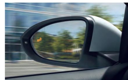
リヤバンパーに内蔵されたレーダーセンサーを使用し、側面および後方車両との車間距離と車速の差を測定します。ドライバーの死角となる後方側面に車両を検知した際、ドライバーが方向指示器を操作すると、ドアミラーに内蔵された警告灯が点滅しドライバーに注意を促します。
