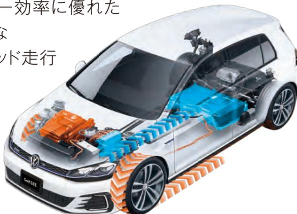
シフトレバー横に配置された**E-MODE**ボタンで、「**Eモード**」から「**ハイブリッドモード**」へ切り替わります。リチウムイオンバッテリーの充電レベルや、ドライバーの運転スタイルに応じて最適なパワーソースを自動選択。比較的低速域で走行している場合には電気モーターが選択され、**TSI**®エンジンは停止した状態となります。アクセルペダルを緩やかに操作することで電動駆動による運転領域を広げることが可能です。アクセルペダルを素早く踏んだ時やリチウムイオンバッテリーの充電レベルが低下した場合には**TSI**®エンジンが自動的に始動します。回生により充電レベルが回復し、ドライバーが緩やかなアクセル操作を続けると、電気モーターのみでの駆動に復帰します。
