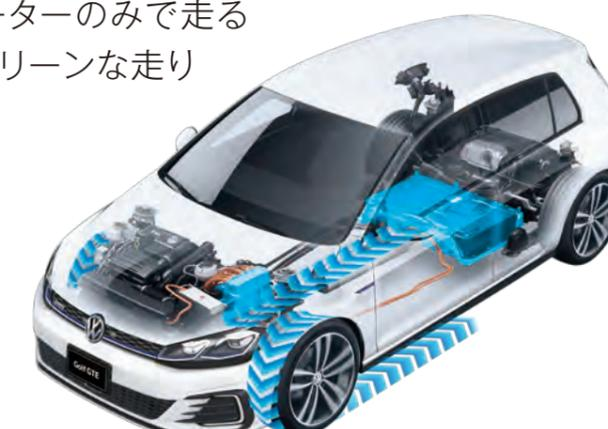
イグニッションオン時は自動的に「**Eモード**」に選択されます。リチウムイオンバッテリーの充電レベルが良好であれば**TSI**®エンジンを始動することなく、日常的な走行シーンの大半をEV走行でカバーすることが可能です。スタート時にバッテリーが満充電の状態であれば、排気ガスを出すことなく最長で約45km\*2を走行。電動駆動だけで時速130km\*3を発生します。エネルギーフローディスプレイには、加速中はバッテリーから電気モーターに向けて、また駆動輪の進行方向に向かって青色の矢印が表示されます。「**Eモード**」を選択していても、リチウムイオンバッテリーの充電レベルが低かったり、外気温がとても低い場合にはエンジンが始動します。
