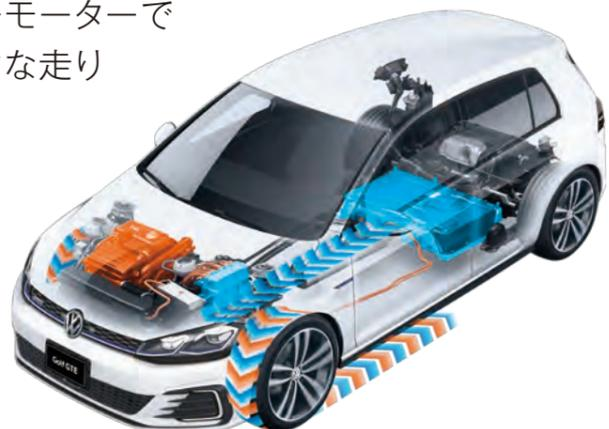
「**GTEモード**」を選択するとエンジンとトランスミッションはスポーツモードのマップに切り替わり、アクセル操作に対するエンジンレスポンスが向上。ダイナミックなドライブフィールを提供します。ステアリングはダイレクトな操作感が高まり、エンジンサウンドはスポーツモードに相応しい力強いサウンドへとチューニングされます。また、アクセルペダルをいっばいに踏み込みキックダウンすると、**TSI**®エンジンと電気モーターが同時に作動し、「**GTEモード**」の醍醐味であるエレクトリックブーストが発動します。エネルギーフローディスプレイには、**TSI**®エンジンが発生している動力は橙色、電気モーターが発生している動力は青色の矢印で表示され、両方のパワーソースで駆動していることを示します。
