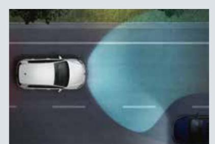
**ステアリングの動きに連動して照射。**
