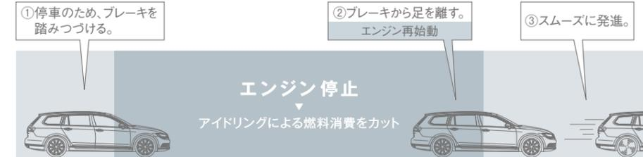
アイドリングストップ技術により無駄な燃料の消費を抑えるシステム。車両を停止させる際にブレーキペダルを踏みつけると、車両停止直前または停止完了時にエンジンが停止。発進の際はブレーキペダルから足を離せばスムーズに再始動\*します。また、事故防止のために運転席のシートベルト解除やドアの開閉などを行った場合には、エンジンを再始動させない安全機構が備わっています。
